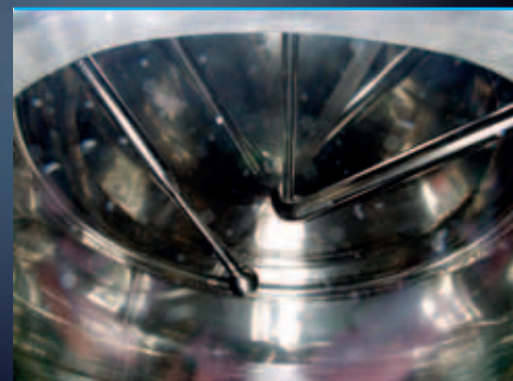
Fundo e contrafundo patenteado Albrigi Superbottom com esfera de lavagem Sprayball
