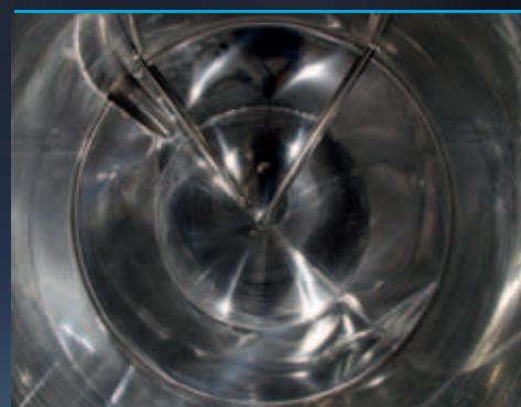
Vista de baixo de um fundo patenteado Albrigi Superbottom com canais de purga do ar da tampa
